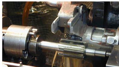
Hinterschleifen eines Rillenfräasers
