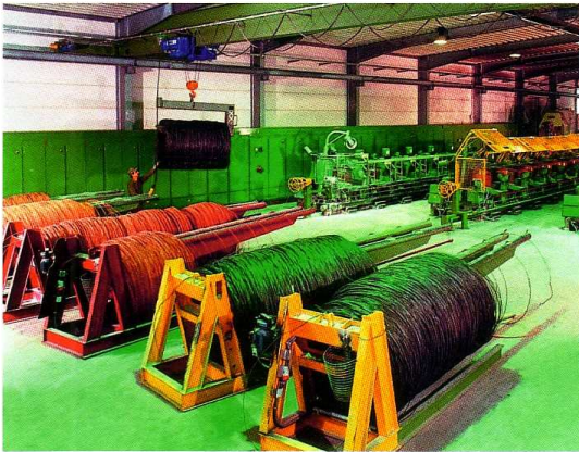
Mit Nylon oder Polymer beschichtete Drähte werden teils zu Spiral- oder Drahtkammbindungen weiter verarbeitet
