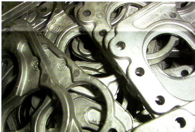
Anschlussplatte: technisches Gussteil aus der Heizungsindustrie
