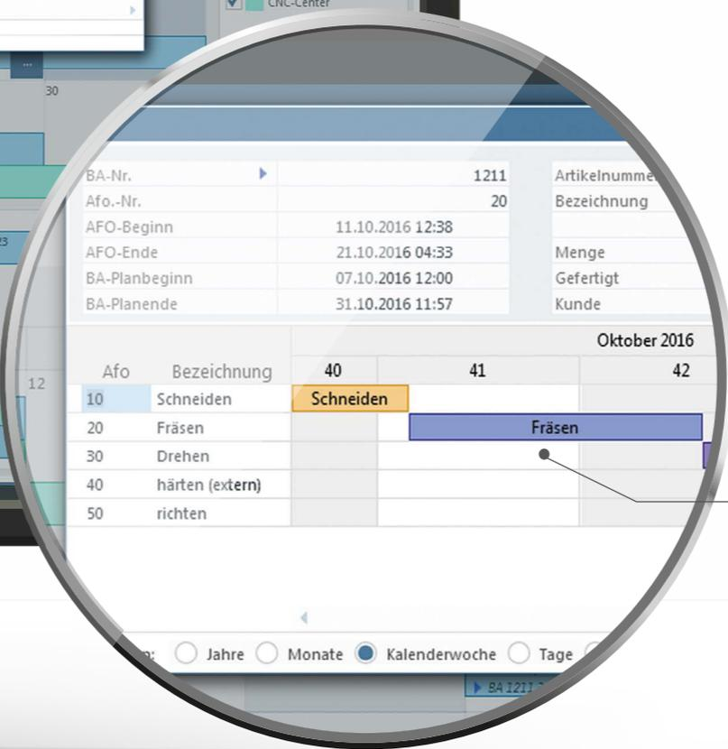
Die Feinplanung erlaubt Ihnen, die Aufträge per Drag-and-Drop zu sortieren und der gewünschten Maschine zuzuweisen. Jede Maschine wird in ihrem eigenen Kalender geplant. Per Doppelklick sehen Sie anschließend eine Übersicht über alle Arbeitsfolgen.
